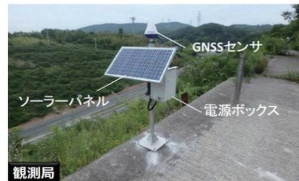
図-1 GNSS 機器の斜面設置イメージ
