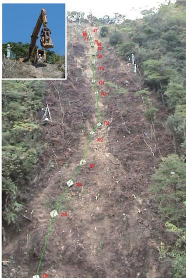
写真-4 愛媛県土居町の自然斜面での落石実験
