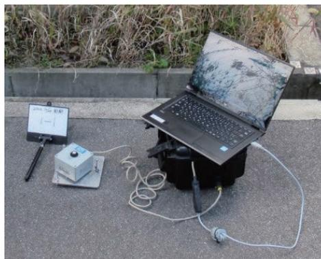
写真-1 常時微動測定状況の例(測点 1-1)
