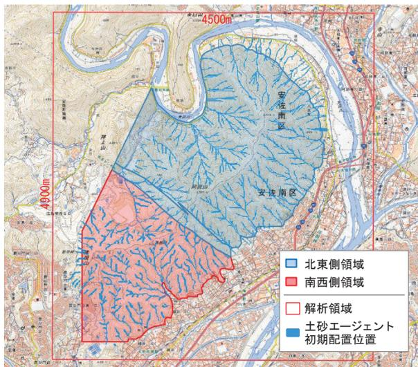
図-5 地質に基づく領域区分および土砂エージェント初期配置(土砂エージェント初期配置見直し検討)
