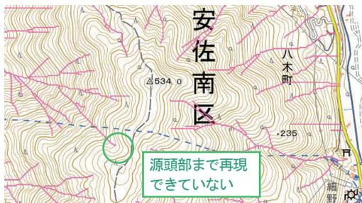
図-3 谷筋の抽出例 (限界セル数:150)<sup>5)に加筆</sup>
