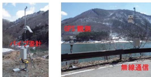
図-4 ダム貯水池周辺斜面の変位計測例
