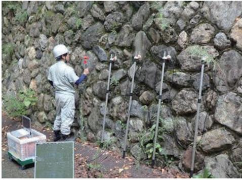
図-5 擁壁の表面波探査状況
