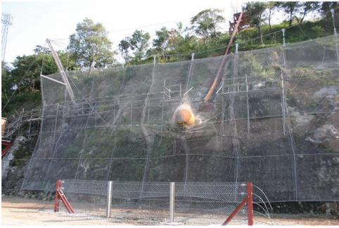
写真-7 ロングスパン工法の性能検証実験
