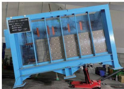
写真-2 模型傾斜状態 (Case2  $k_h=0.24$ )
