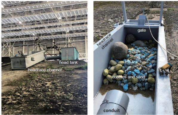
図-12 土石流発生装置と土砂の装填状況
