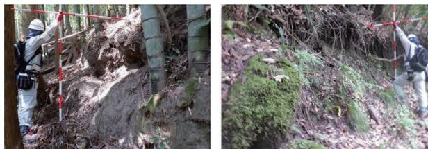
写真-1 連続性のある滑落崖 写真-2 表層クリープ状況
