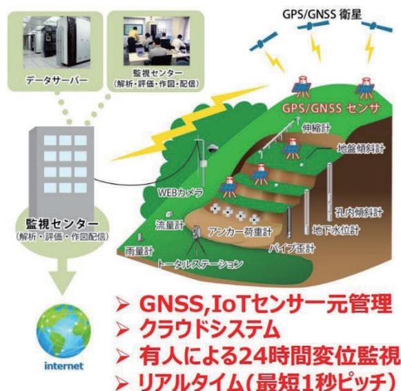
図-2 クラウド型自動計測システム shamen-net の特長
